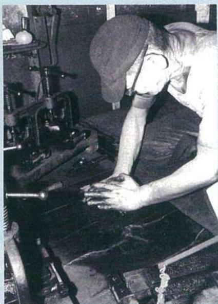
煤煙と膠を機械で練り合わせた後、仕上げに手でしっかりととなじませます。
