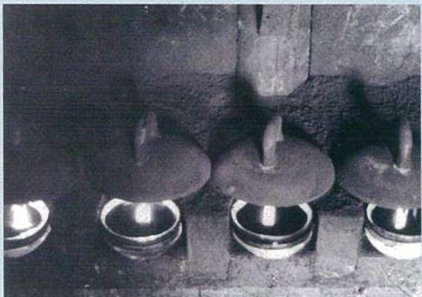
受け皿になたね油を入れ、その中に燈芯を立てて点火し、上蓋に付着した煤煙を集めます。
