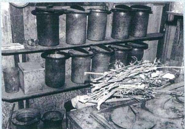
墨のもう一つの主原料である膠は、水を入れた銅製のタンポの中で長時間煮て溶かします。
